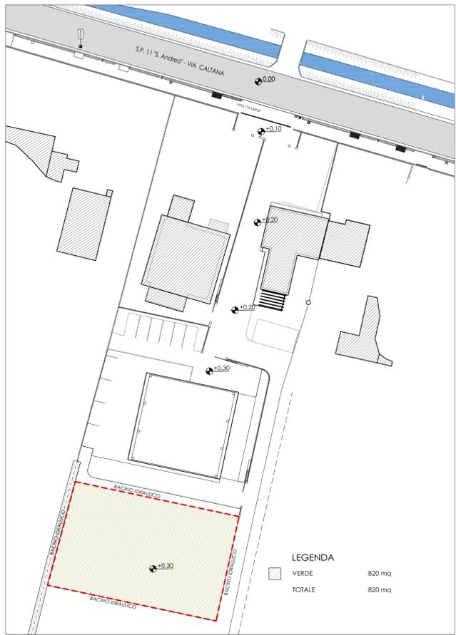
PLANIMETRIA STATO CONCESSIONARIO - RETE ACQUE METEORICHE ANALISI DEL COEFFICIENTE DI DEFLUSSO DELLE SUPERFICI - scala 1:500
