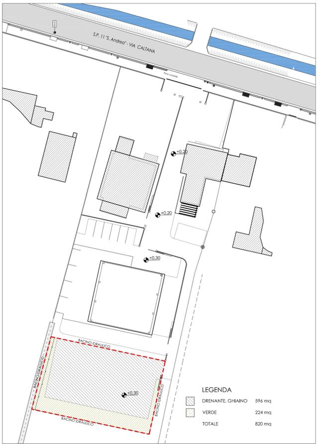
PLANIMETRIA STATO DI PROGETTO - RETE ACQUE METEORICHE ANALISI DEL COEFFICIENTE DI DEFLUSSO DELLE SUPERFICI - scala 1:500
